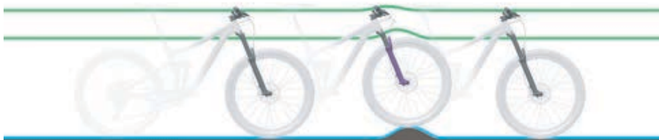
Abbildung 7: Optimales Fahrverhalten der Gabel bei Unebenheiten
