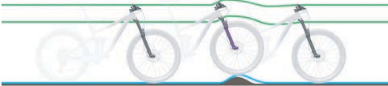
Abbildung 72: Zu harte Dämpfung der Federgabel bei Unebenheiten
