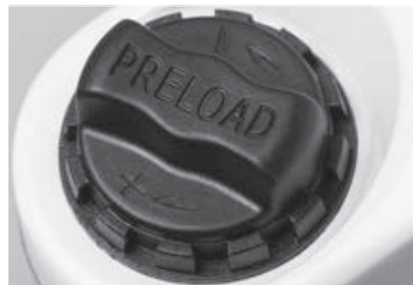
Abbildung 40: Einstellrad SAG auf der Krone der Federgabel
