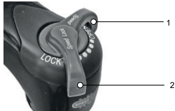
Abbildung 62: Suntour-Druckstufendämpfer in offener (1) und geschlossener (2) Position
