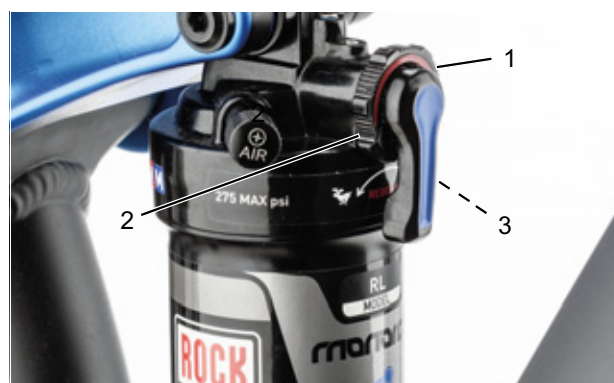
Figura 82: Regolazione della rigidità dell'ammortizzatore a stadi di trazione con la manopola di regolazione (1) dell'ammortizzatore del carro posteriore
