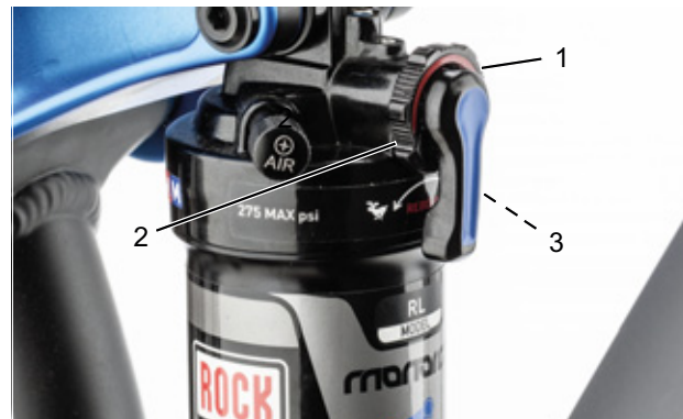
96. ábra: A húzófokozatos lengéscsillapító keménységének beállítása a hátsó lengéscsillapító beállító kerekével (1)
