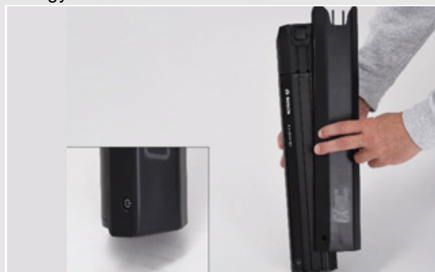
39. ábra: Az akkumulátorfedél rátolása az akkumulátorra
