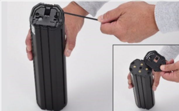
36. ábra: A felső csatlakozó felület kiszérése
