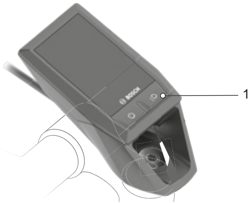
90. ábra: A világítás gomb elhelyezkedése
