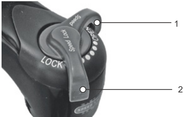
95. ábra: Suntour nyomásfokozat-beállító OPEN (1) és LOCK (2) pozíciókkal
