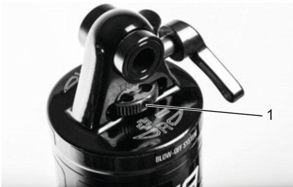
75. ábra: Suntour kerék húzófokozat-beállító (1) a hátsó lengéscsillapítón
