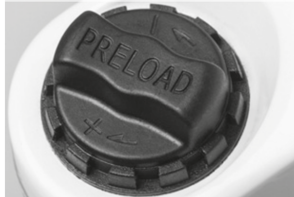
71. ábra: A negatív rugóút beállító kereke a teleszkópos villa koronáján
