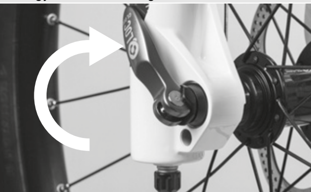
55. ábra: A gyorszár zárása
