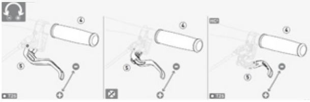
69. ábra: Magura tárcsafék fékkar markolási szélességének beállítása
