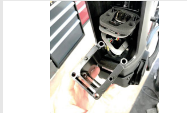
30. ábra: A PowerTube adapter kihúzása
