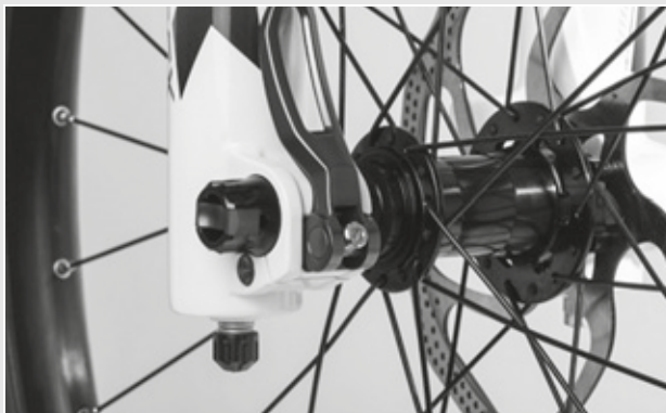
50. ábra: A gyorskioldó kar tökéletes helyzete
