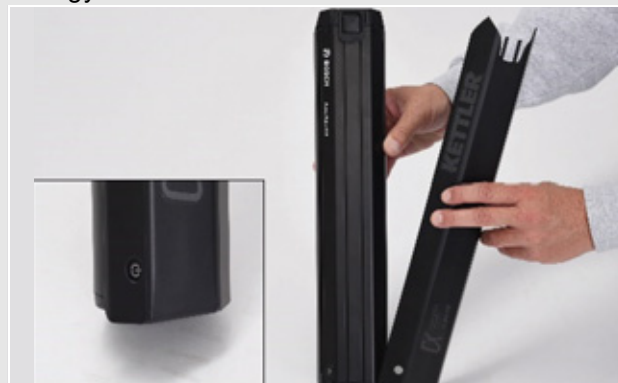
35. ábra: Az akkumulátorfedél rátolása az akkumulátorra
