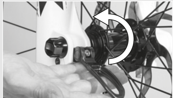
49. ábra: A kar rögzítése
