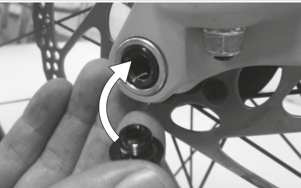
42. ábra: A gyorskioldó kar betolása a tengelybe
