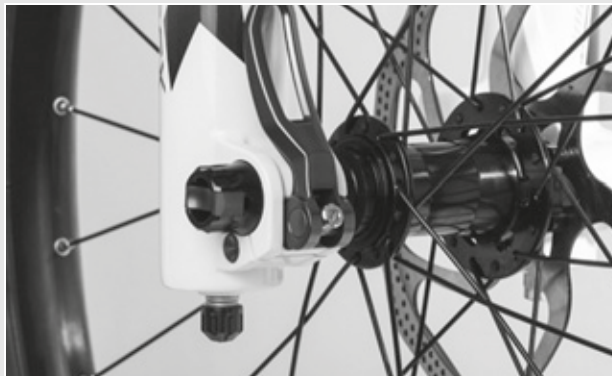
Rysunek 88: Ustawianie siły mocowania zacisku szybkomocującego
