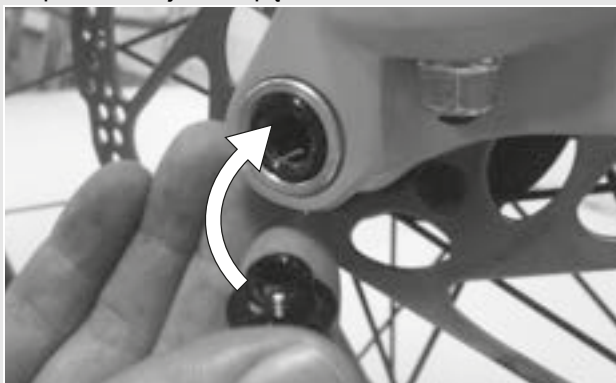
Rysunek 28: Sposób wsuwania dźwigni zacisku szybkoocucującego w os
