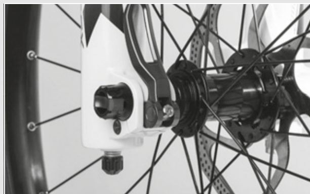
Rysunek 36: Optymalne położenie dźwigni mocującej
