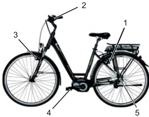
Rysunek 12: Układ hamulcowy roweru typu Pedelec z hamulcem nożnym, przykład
