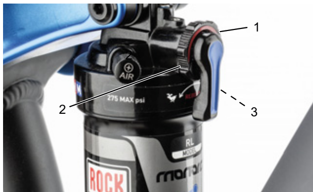
Rysunek 83: Ustawianie twardości tłumika odbicia za pomocą pokrętła regulacyjnego (1)
