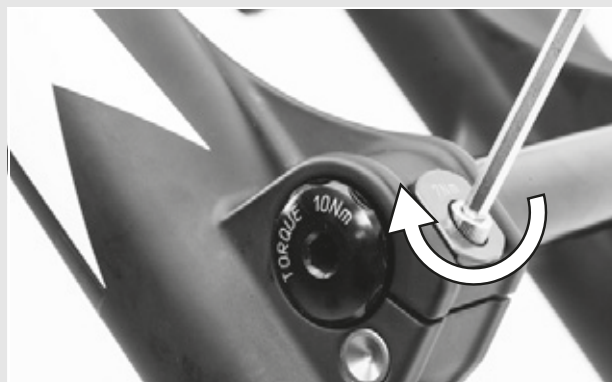
Rysunek 31: Sposób dokręcania osi
